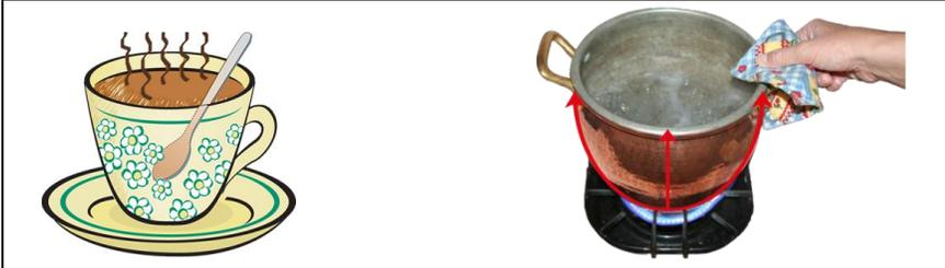
La conducción se produce gracias a las colisiones moleculares que se dan al interior de un material. Cuando se calienta el extremo de un objeto, las moléculas en su lugar se mueven cada vez más rápido, chocando con sus moléculas vecinas y transfiriendo parte de su energía cinética (**figura 2**).
